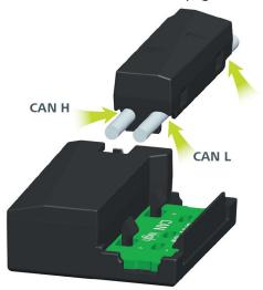
8. Positionieren Sie den Clip so am Sensor, dass die Kabel für CAN Low und CAN High an den entsprechenden Seiten des Sensors liegen.
